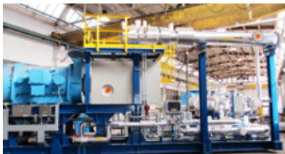
Compresor PSA Rusia - 400L / 1320kW
